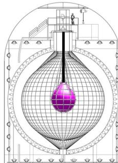
カムランド実験の模式図：直径18mの球形タンク内面に約2000本の光電子増倍管が装着され、直径13mのナイロンパリレンに満たした液体シンチレータの発光をモニターしています。本研究計画では、さらに中心に<sup>136</sup>Xe含有液体シンチレータを封入した直径4mのミニバルーンを吊り下げ、逆階層領域に切り込む感度でニュートリノレス二重ベータ崩壊を探査します。
