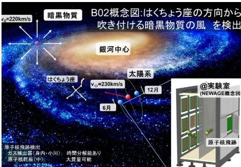
方向に感度を持つ暗黒物質直接探索: 私たちのすむ銀河は暗黒物質に取り囲まれています。太陽系の運動のため、暗黒物質は進行方向(はくちょう座の方向)から多く到来しています。原子核の飛跡を検出可能な検出器を用いて、方向に感度を持つ探索を行います。
