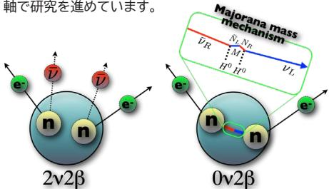
通常の二重ベータ崩壊(左)とニュートリノレス二重ベータ崩壊(右)：通常の二重ベータ崩壊では、2つの反ニュートリノと2つの電子が放出されます。ニュートリノレス二重ベータ崩壊では、2つの電子だけが放出されます。本領域ではニュートリノレス二重ベータ崩壊の発見を目指します。
