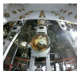
B01班が大きな役割を果たすガドリニウムを用いた中性子検出器の建設風景。運転時はガドリニウムを溶解した水を満たし、中性子捕獲によるチエレンコフ光を検出します。直径25cmの光センサが見えます。
