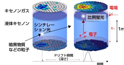
液体キセノン検出器の原理。約4トンの超高純度液体キセノンに暗黒物質が衝突するとシンチレーション光（左）と比例蛍光（右）が生じ、それらを上面と底面の光センサが捉えます。下の中性子検出器と併せてこれまでより1桁高い感度で暗黒物質を探します。
