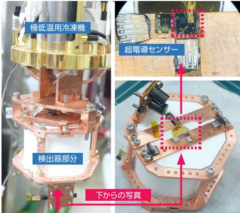
左：絶対零度近く（0.01K）まで冷却するための冷凍機に取り付けられた $0\nu2\beta$ 崩壊探索用に開発中の検出器。
