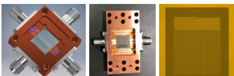
左：裏と表から信号を読み出せる新しい発想を取り入れた開発中のKID検出器と呼ばれる超伝導センサーを応用了した検出器のデザイン。
