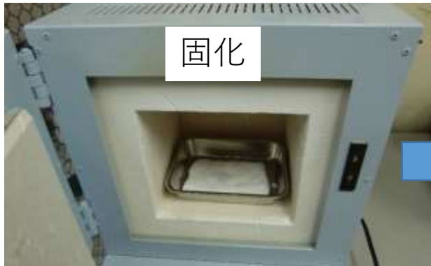
MS4Aパウダーにアルミナゾルを混ぜ、電気炉で焼結
