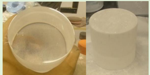
図11 新しい NaI(Tl)結晶(Ingot #120) 結晶寸法 \phi 7.74 \times 7.70 \text{ cm}^3 結晶質量 1317 g エネルギー分解能@662 keV 9.7%(開発時) 12.7%(神岡)
