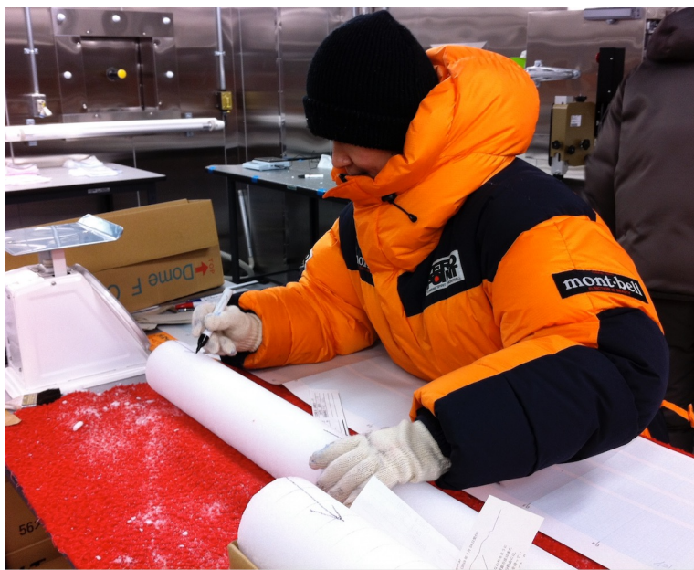
コアを切断する前、形状記録をしている様子(望月)
