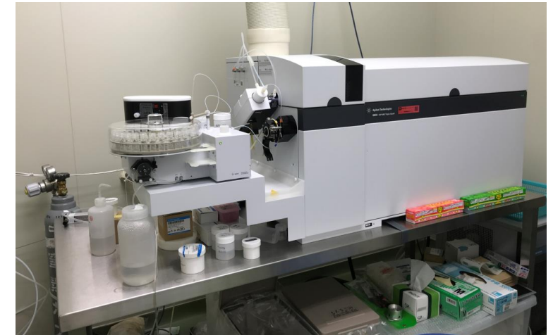
ICP-MS (水溶液試料の元素分析)
