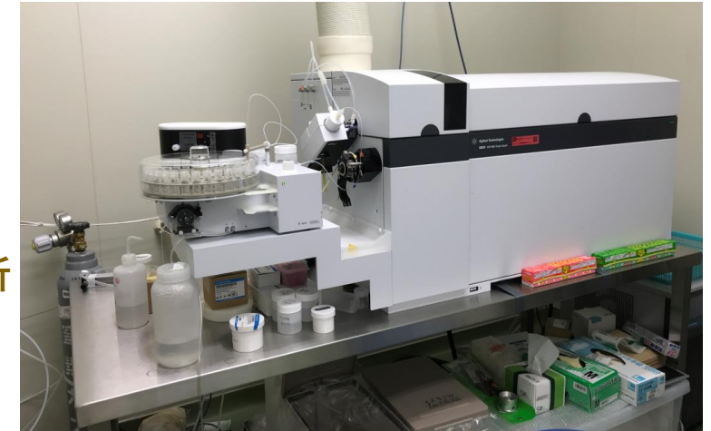
ICP-MS (水溶液試料の元素分析)
