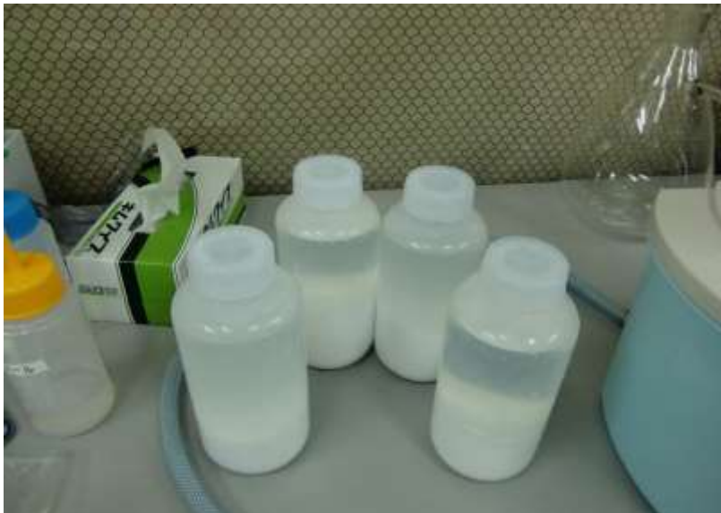
MS4A結晶化後の写真。恒温槽で放置し、上：透明、下：白に分離していれば成功
