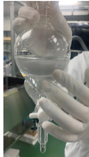
分液漏斗で液液抽出を行う様子
