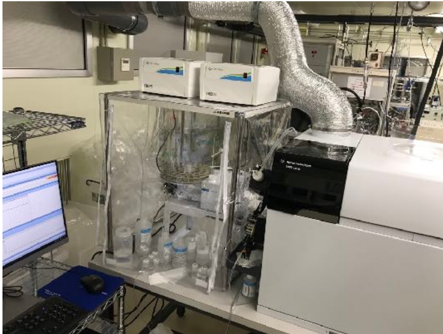
2台目ICP-MSとクリーンブース (Lab1) 8
