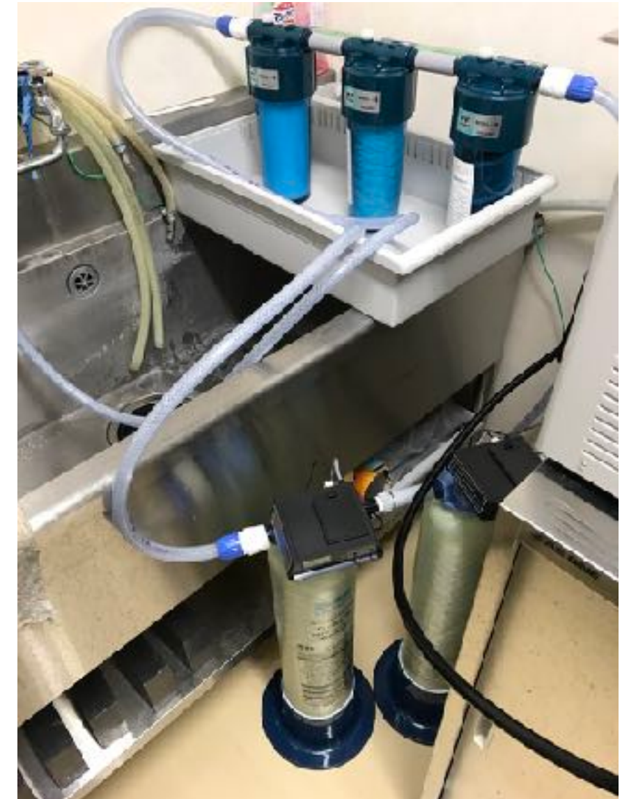
超純水製造装置(自作)
