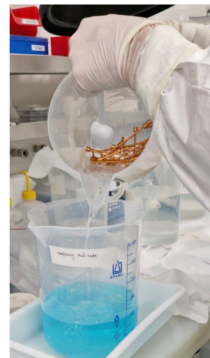
Cu rods etching
